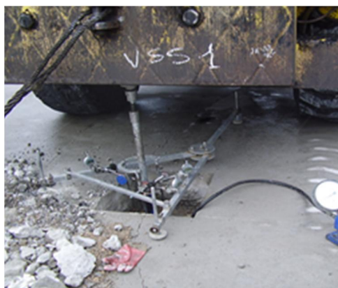
Rys. 8. Badanie płytą VSS w punkcie VSS1.
