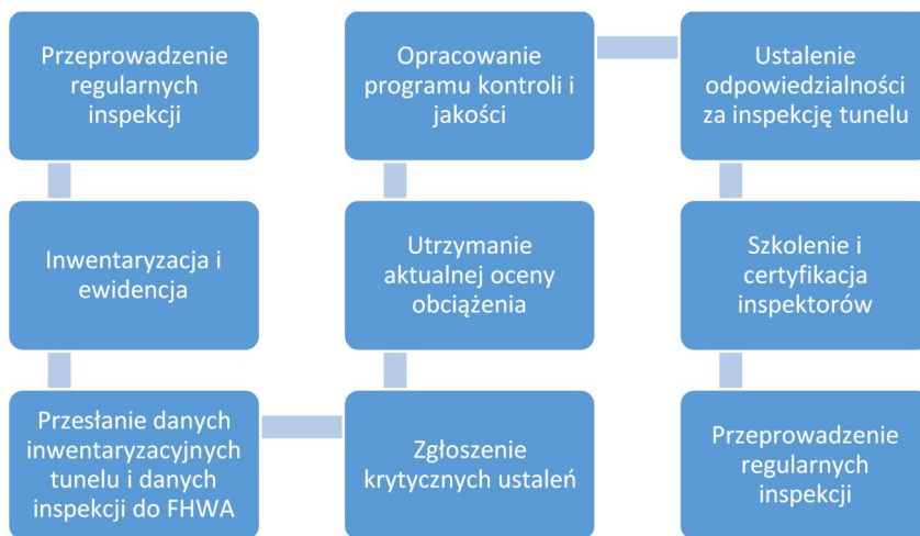
Rys. 5. Schemat realizacji inspekcji tunelu i wymagania w ich zakresie
