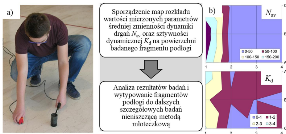
Rys. 5. Przykładowe badania zespolenia płyt kamiennych z podkładem cementowym w podłodze wielkopowierzchniowej nieniszczącą metodą odpowiedzi na impuls: a) widok badania, b) wyniki badań w postaci map rozkładu parametrów N_{av} i K_d .
