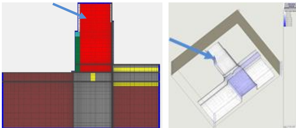
Rys. 9. Model numeryczny cokołu w Skórcu z częścią ściany fundamentowej zagłębionej w gruncie wraz z wynikiem symulacji – widoczny znaczący przyrost ilości wody po 3 latach eksploatacji.
