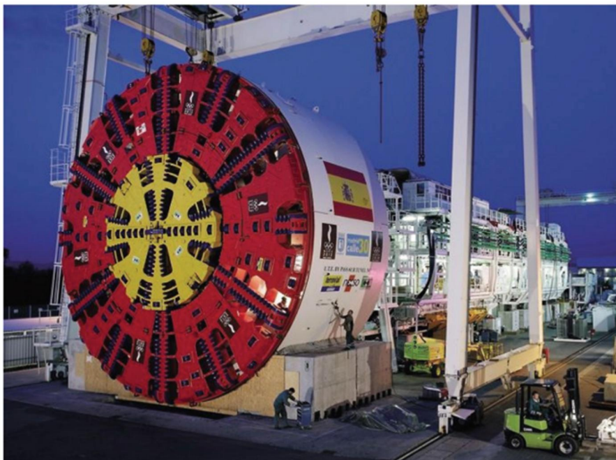
Rys. 5. Maszyna Herrenknecht S-300 EPB TBM typu dual mode o średnicy 15,12 m.
