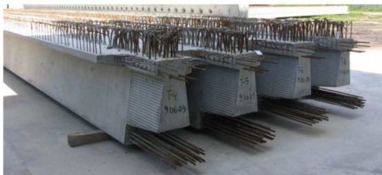
Rys. 1. Przekrój poprzeczny belki typu T (lewo). Dźwigary typu T składowane w wytwórni (prawo) [materiały promocyjne firmy Sibet]
