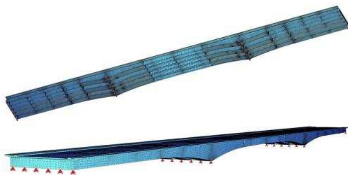
Rys. 15. Model numeryczny MES w środowisku MES SOFiSTiK
