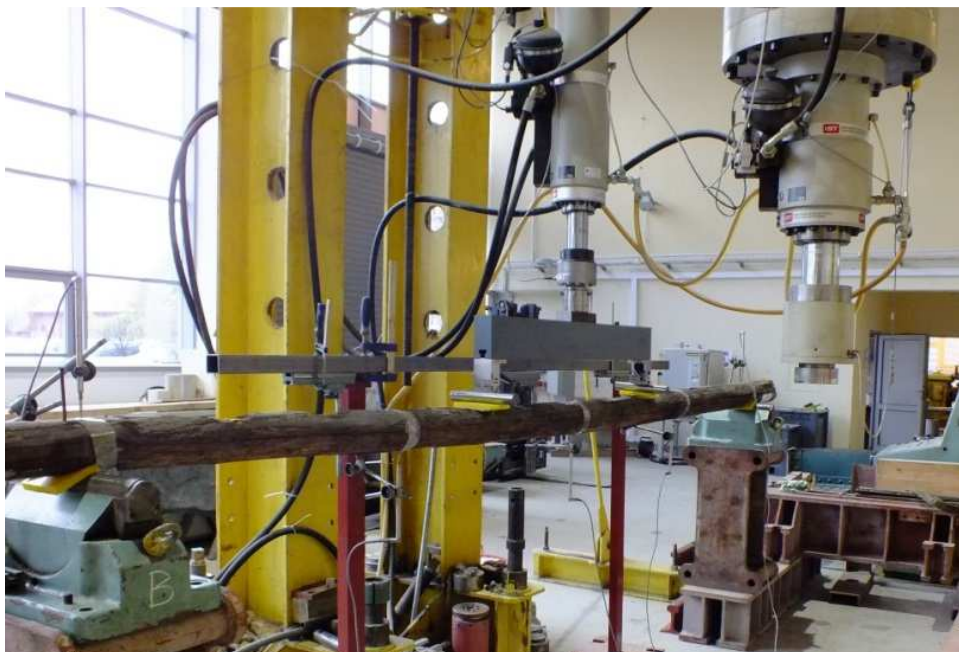
Rys. 11. Stanowisko do badań krokwi zdemontowanych z baraków więźniarskich
