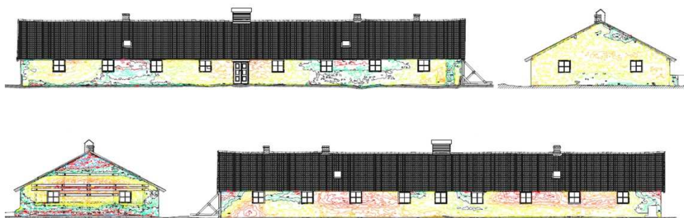
Rys. 4. Mapa warstwicowa deformacji zewnętrznych murowanych ścian baraku B-124 (kolorem czerwonym zaznaczono miejsca największych deformacji)
