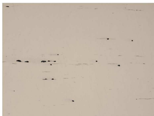
Rys. 11. Powierzchnia przekroju główki szyny R340GHT równoległa do kierunku walcowania; pow. 100×; zgląd nietrawiony
