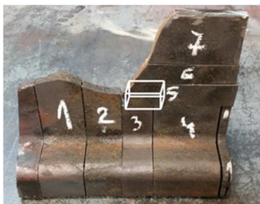
Rys. 6. Widok pękniętej szyny R260, z której pobrano próbki do badań metalograficznych
