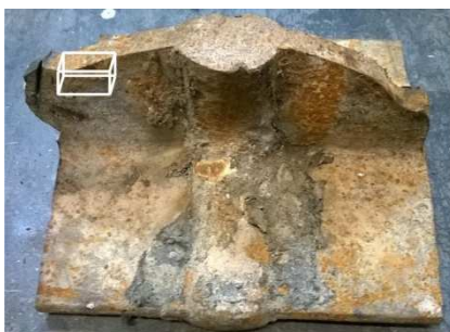
Rys. 7. Widok pękniętej szyny R340GHT, z której pobrano próbki do badań metalograficznych
