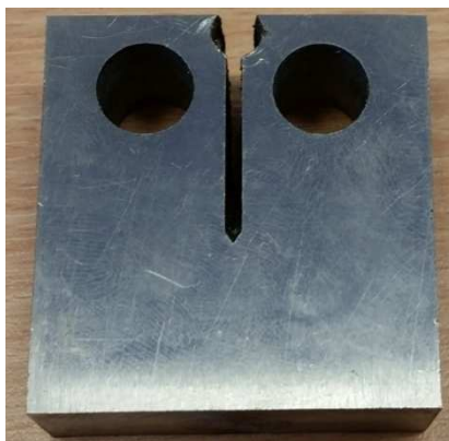
Rys. 4. Próbkę zwarta do badania odporności na pękanie
