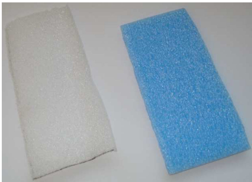
Rys. 4. Mata pobrana z odkrywki (biała) oraz mata Ethafoam (niebieska)
