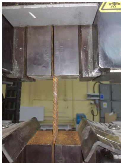
Rys. 14. Pręt zbrojeniowy po badaniu
