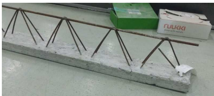
Rys. 12. Belka po badaniu wytrzymałości na ścinanie
