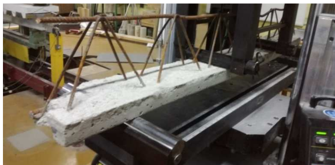
Rys. 10. Belka umieszczona w maszynie do badania wytrzymałości na zginanie
