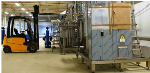
Rys. 3. Urządzenia technologiczne przekazujące siły skupione na strop
