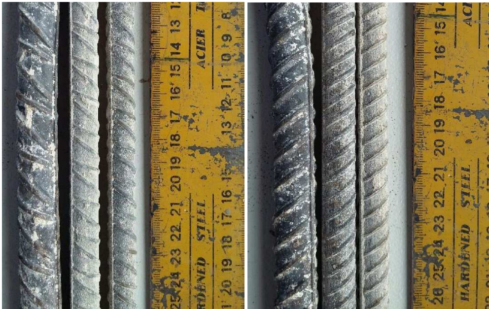
Rys. 10 Próbkki stali pobrane z konstrukcji do określenia wytrzymałości na rozciąganie
