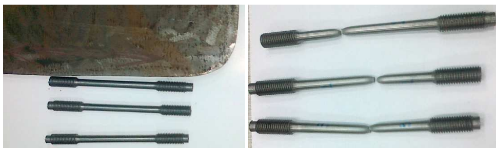
Rys. 4. Próbkę przed i po badaniu na rozciąganie oraz wycięta blacha z płaszczu zbiornika
