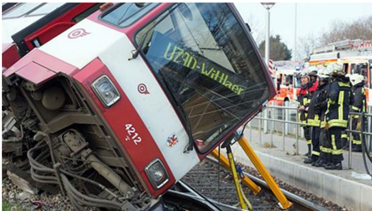
Rys. 23 Wykolejony tramwaj podparty zabezpieczająco podporami MULTIPROP
