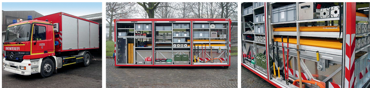
Rys. 22 Wyposażenie kontenera ratowniczego Straży Pożarnej w Niemczech (widoczne żółte podpory PERI MULTIPROP)
