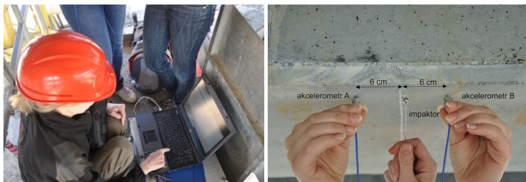
Rys. 10. Stanowisko pomiarowe, położenie punktów pomiarowych względem wymuszenia
