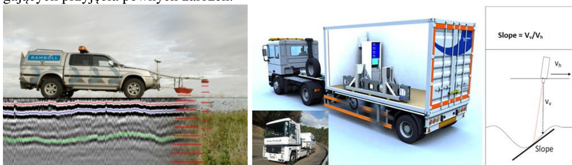
Rys. 1. System pomiarowy GPR [ http://www.scopus.com.pl/uslugi/uslugi-dla-zarzadcow-drog/diagnostyka-nawierzchni/ ] i ugięciomierz laserowy TSD [ http://www.ndtoolbox.org/content/pavement/d-physical-principle ]
