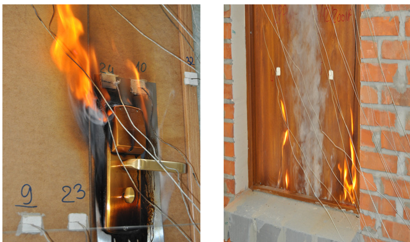
Rys. 5. Przykład nieprawidłowo dobranego okucia (z lewej) i brak odpowiednich uszczelek pęczniejących (z prawej)
