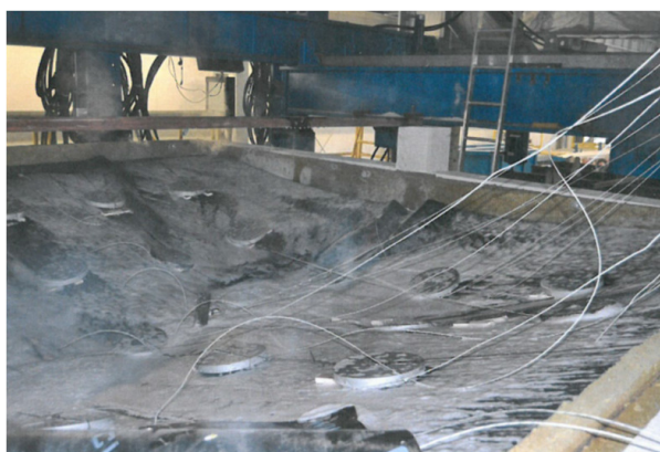
Rys. 7. Widok elementu próbnego dachu z płyt warstwowych po badaniu odporności ogniowej od strony nienagrzewanej
