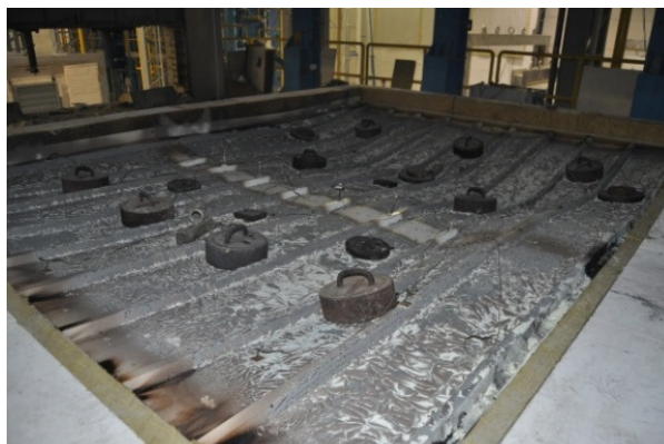
Rys. 6. Widok elementu próbnego dachu z płyt warstwowych podczas badania odporności ogniowej
