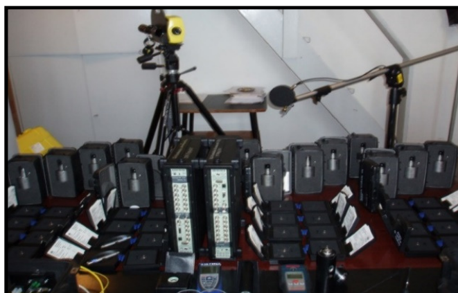
Rys. 8. 34 kanałowy system systemu PULSE 3560 firmy Brüel & Kjær do pomiaru i analizy drgań
