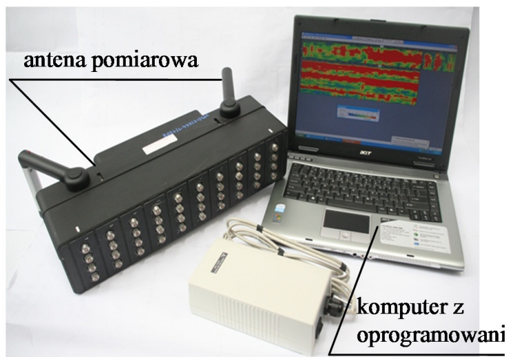
Rys. 4. Widok tomografu ultradźwiękowego
