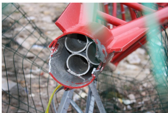
Rys. 4. Widok segmentu podstawy masztu bezpośrednio po awarii
