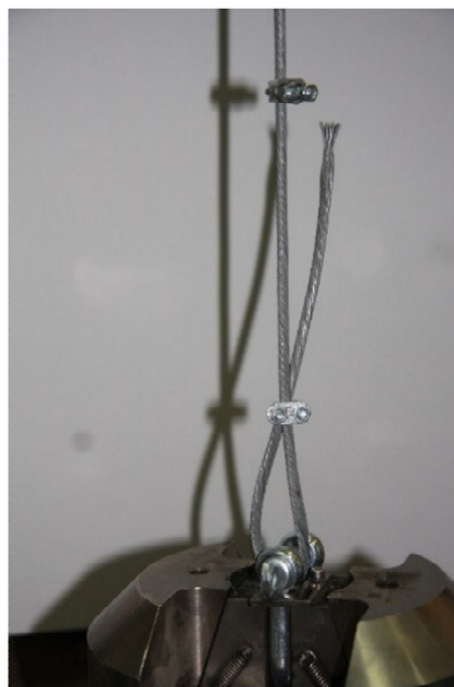
Rys. 8b. Widok zakotwienia liny odciągu po badaniu – wysunięcie liny z zacisków
