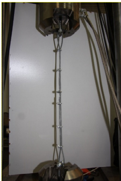
Rys. 8a. Widok badanego zakotwienia liny odciągu w maszynie wytrzymałościowej
