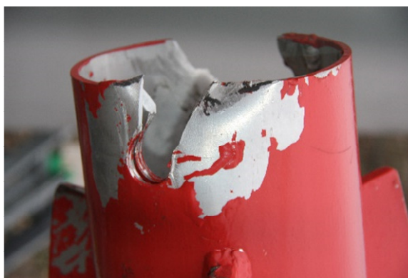
Rys. 4. Widok segmentu podstawy masztu bezpośrednio po awarii
