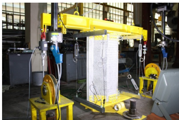
Rys. 3. Stanowisko do badań profilowanej blachy a) widok stanowiska badawczego b) schemat obciążenia
