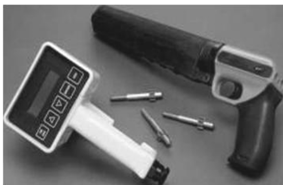
Rys. 4. Zestaw do pomiaru wytrzymałości na ściskanie metodą sondy Windsor oraz wykresy przedstawiające zależność między długością wystającej części sondy ( D ) i wytrzymałością na ściskanie betonów wykonanych na kruszycach o twardości od 3 do 7 w skali Mohsa [12]
