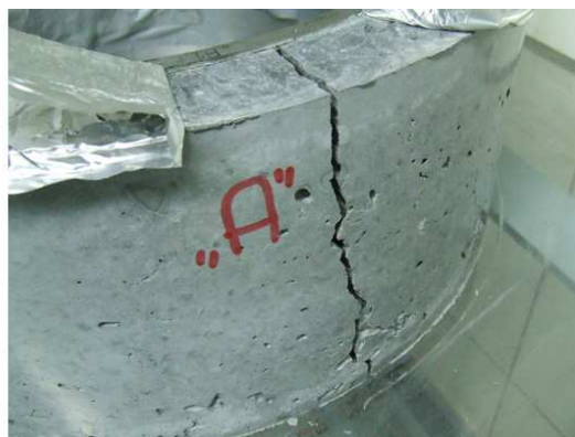
Rys. 7 Pomiar oddziaływania skurczu ograniczonego wg ASTM C 1581-09 C: a) przekrój przez stanowisko badawcze, b) próbka po pęknięciu - zakończeniu badania.
