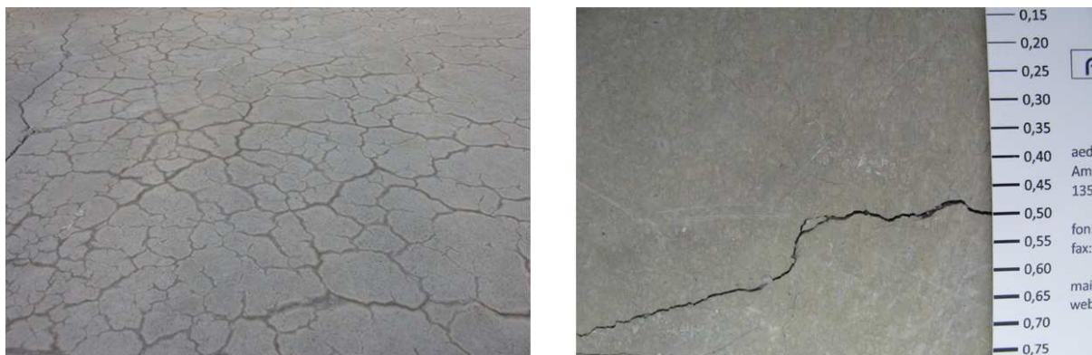
Rys. 3 Pęknięcia powierzchniowe betonu spowodowane powierzchniowym skurczem porów kapilarnych w wyniku intensywnego wysychania. [6], [7]
