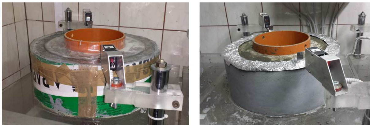
Rys. 11 Badanie swobodnego skurczu liniowego betonowych próbek pierścieniowych z wykorzystaniem czujników laserowych.
