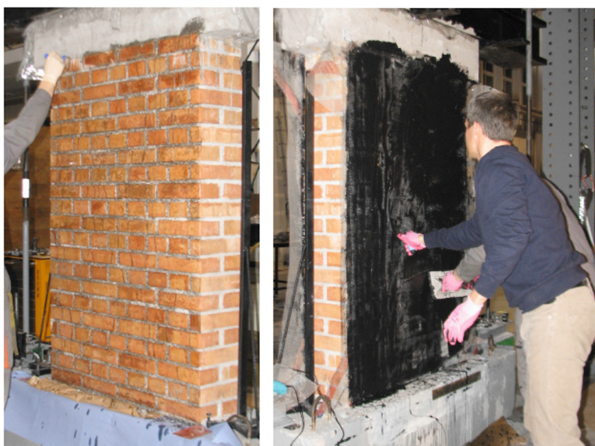
Rys. 4. Ściana BM-R-1 podczas gruntowania przed aplikacją wzmocnienia (po lewej) i ta sama ściana (jako BM-R-1-QR) w trakcie aplikacji wzmocnienia (po prawej)
