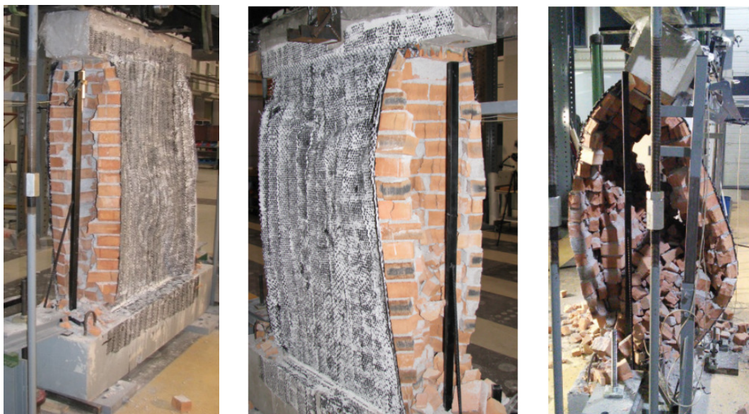
Rys. 6. Postać zniszczenia wzmocnionej ściany
