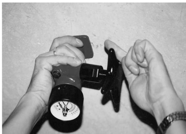
Rys. 5. Przedstawia jeden z pomiarów nośności kołka rozporowego (na wrywanie z płyty stropowej, żelbetowej). Za pomocą profesjonalnego urządzenia mierzy się bardzo dokładnie maksymalną wielkość siły przy której występuje utrata nośności kołka rozporowego. Zakres średnic M4-M10. Obciążenie max 15 \text{ kN}
