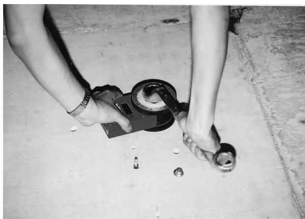
Rys. 6. Przedstawia przyrząd w trakcie badań pomiaru nośności kołka o większej nośności na wrywanie (wyciąganie). Zakres urządzenia pomiarowego: średnice M6-M24. Obciążenie max 100 \text{ kN}
